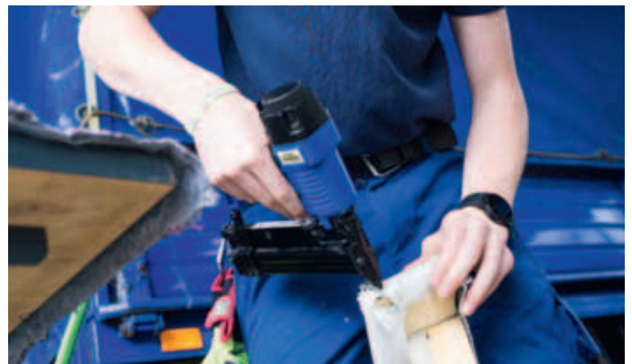
Die Fertigung war aufgeteilt in verschiedene Stationen. Hier tackerte Quirin gerade einen Feuerwehrschräume an das Dach eines Fledermaushäuses. Der sorgt später dafür, dass kein Wasser in das Haus läuft.
