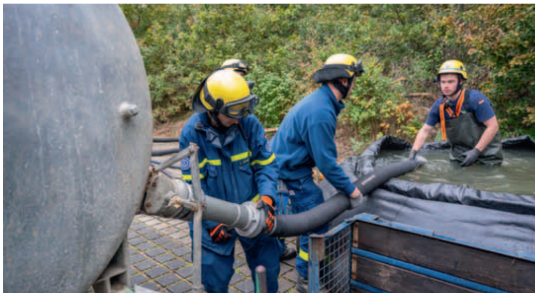
Landwirte unterstützen mit Ihren Güllefässern den Wassertransport. Mittels einer Saugleitung wird aus einem Faltbehälter das Löschwasser in das Güllefass gesaugt. Die Kräfte und Fachgruppen der beteiligten Ortsverbände arbeiten Hand in Hand.
