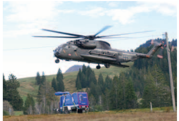
Das Bild zeigt das Absetzen des Notstromerzeugers am Alpengasthof Hörmoos, direkt nach dem Aushängen der Last.
