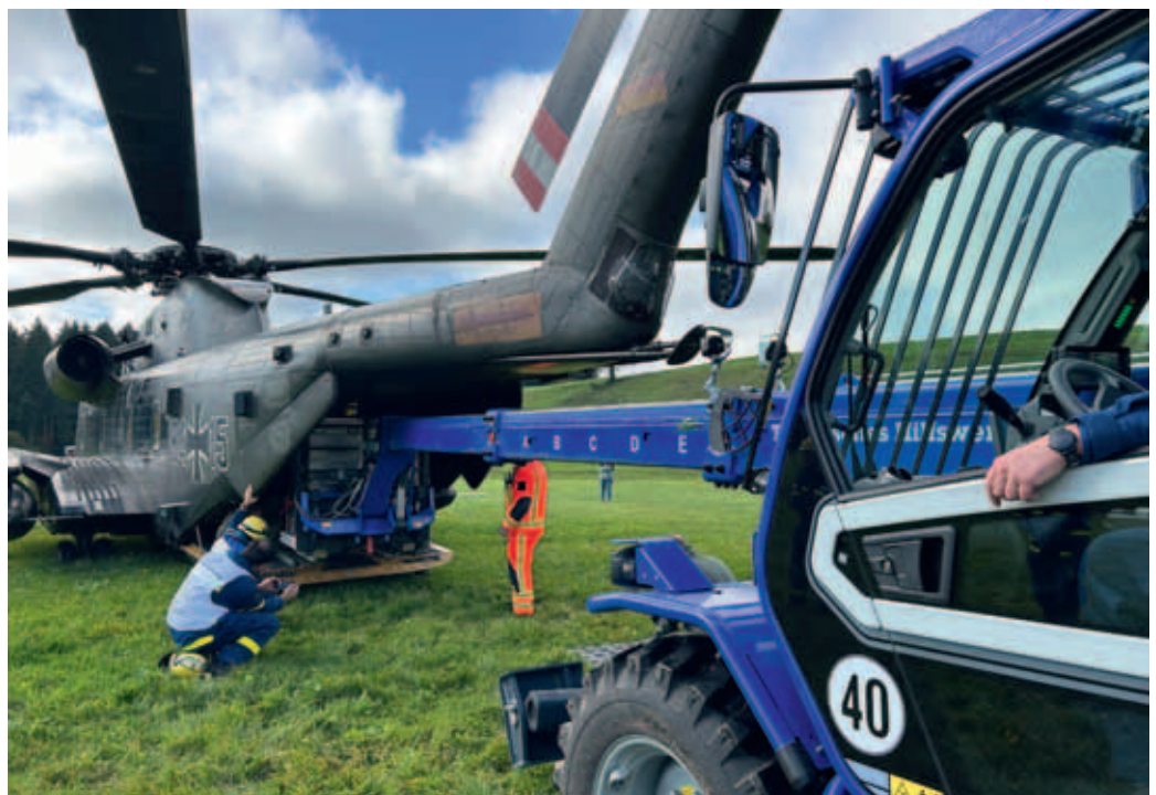
Für die Verladung des THW-Materials wurde eine spezielle Palette in Kooperation mit der Privatwirtschaft, der Bundeswehr und dem THW entwickelt, um den hohen Sicherheitsanforderungen gerecht zu werden. Diese Beladung wurde mittels Teelader von Helfern des Ortsverbands Füssen in enger Abstimmung mit dem zuständigen Beladeoffizier der Bundeswehr durchgeführt.
