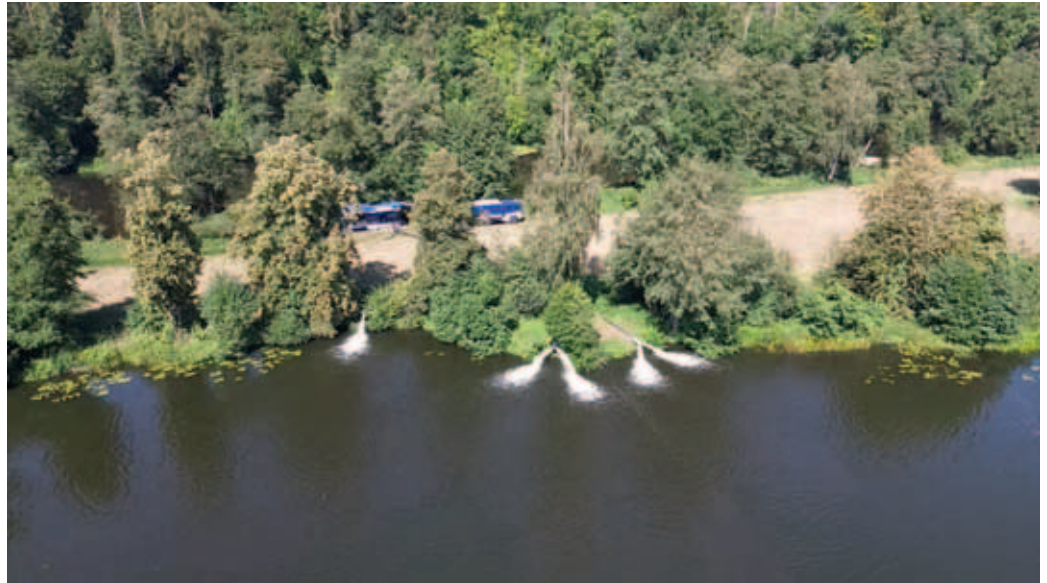
Bei dieser Drohnenaufnahme sieht man deutlich die Aufspaltung der Börgerdruckleitung
